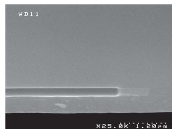
FIGURE 5.15 – Visualisation de la cavité avec arrêt de gravure
