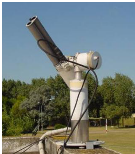
Fig. 2. Radiometro CIMEL 318A NASA. Fonte: AERONET, http://aeronet.gsfc.nasa.gov/ .
