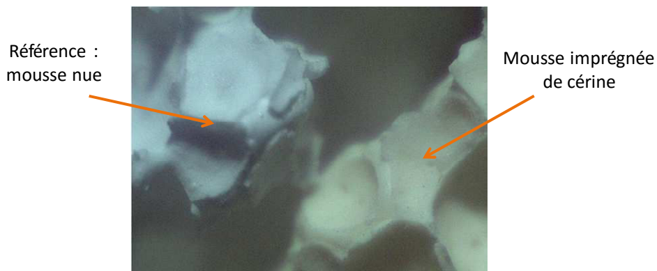
Figure 15 : Comparaison d'une mousse imprégnée de cériine par imprégnation par voie humide en 1 étape (tableau 2 synthèse 1) et de la référence mousse nue.
