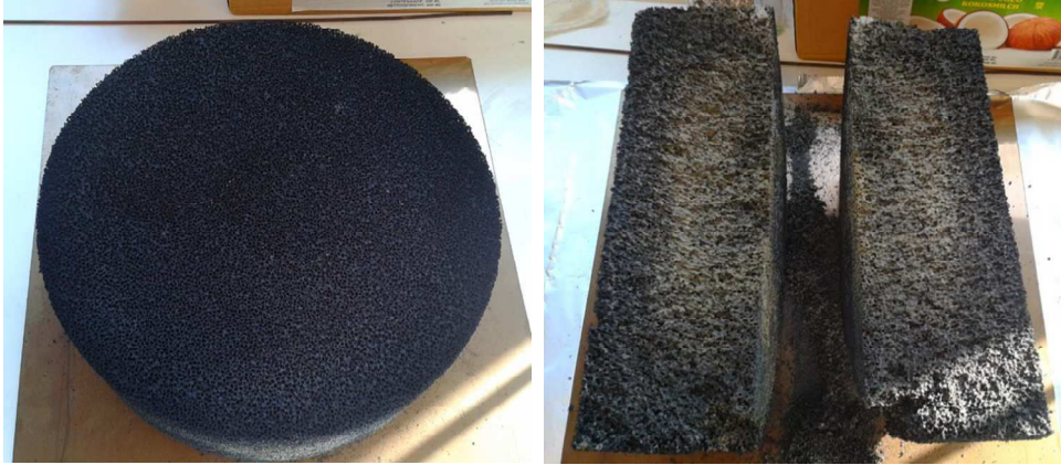
Figure 6 : Homogénéité du dépôt de cuivre 2,5%Cu/7,8%CeO 2 /30ppi (synthèse 4 tableau 3).
