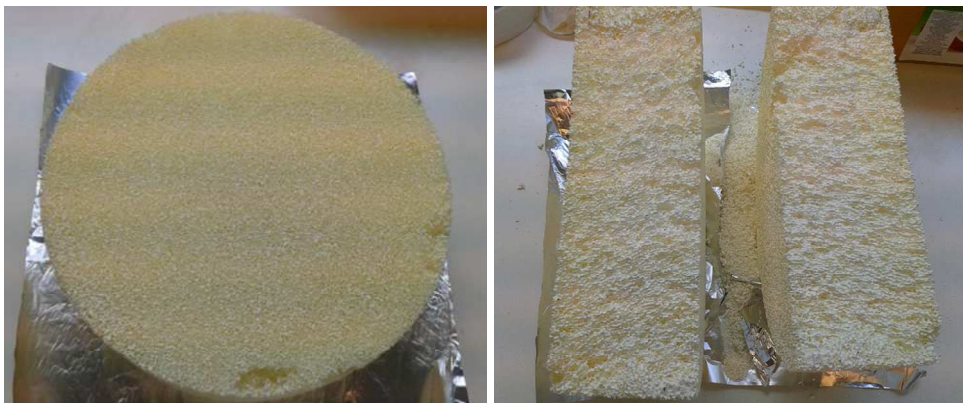
Figure 5 : Homogénéité du dépôt de wash-coat 2,4%CeO 2 /30ppi (synthèse 2 tableau 1).
