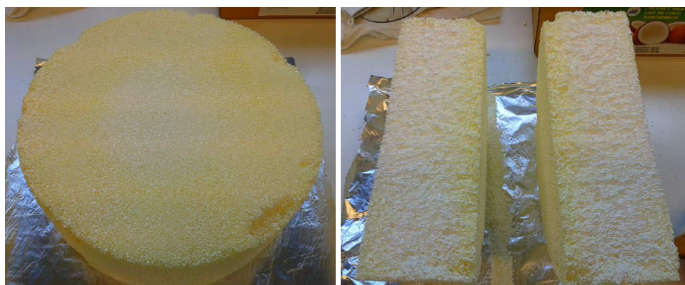
Figure 4 : Homogénéité du dépôt de wash-coat 3,2%CeO 2 /30ppi (synthèse 1 tableau 1).
