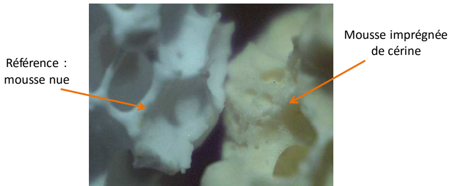
Figure 12 : Comparaison d'une mousse imprégnée de cérine par imprégnation par voie humide en 3 étapes (tableau 2 synthèse 3) et de la référence mousse nue.
