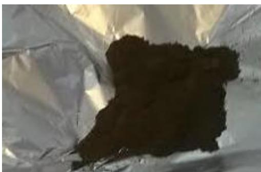
Figure III.2.2 : Cendres d'auto-combustion obtenues avec un rapport glycine/cations métalliques égal à 2.
