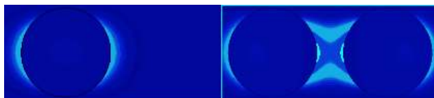
FIGURE 4.1 – Champ électrique en proximité d'une nanoparticule comparé à une antenne dimère. Figure tirée de [15]
