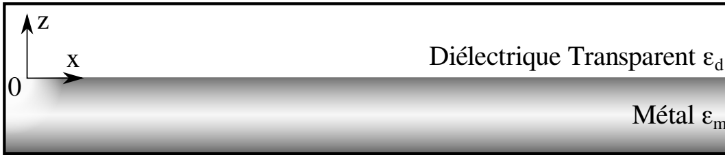
FIGURE 1.3 – Interface métal/diélectrique considérée dans le cas du plasmon propagatif.
