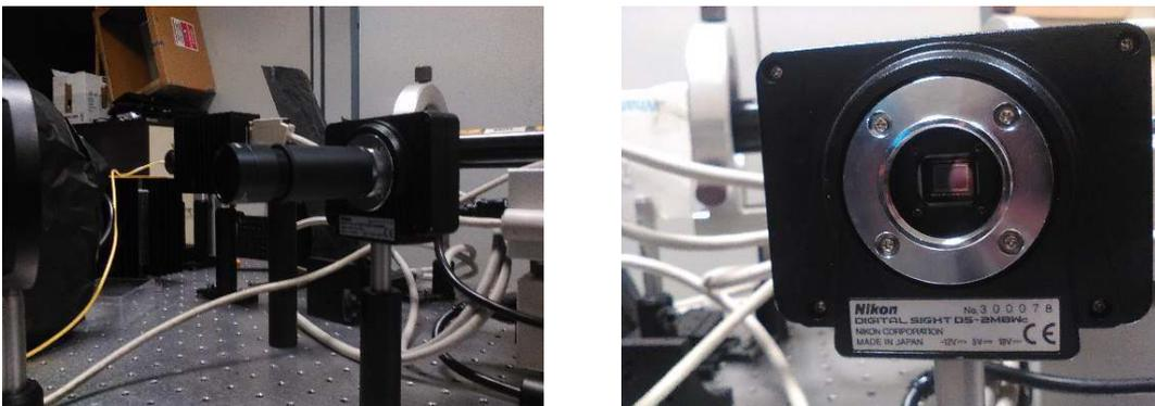
FIGURE 3.3 – La caméra avec et sans son tube de focale.
