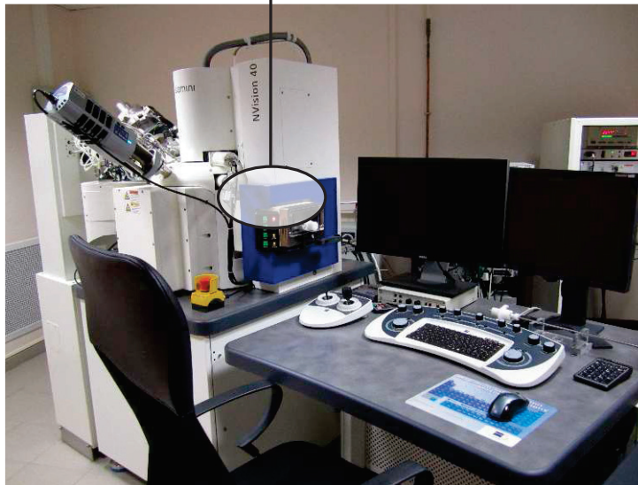
FIGURE 5.4 – Dernière étape de l'élaboration : l'empilement de couches minces est gravé par un faisceau d'ions focalisés.
