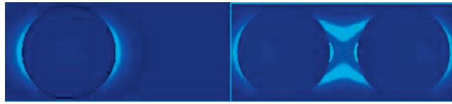
FIGURE 4.1 – Champ électrique en proximité d'une nanoparticule comparé à une antenne dimère. Figure tirée de [15]
