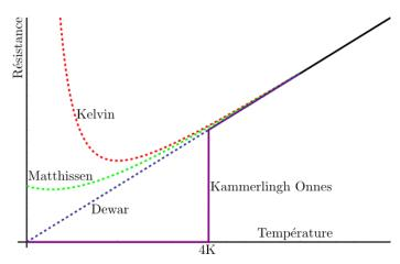
Figure 2 : Résistance du mercure en fonction de la température. Les trois courbes en pointillé sont des modèles théoriques, la courbe pleine décrit le résultat expérimental obtenu par Kammerlingh Onnes en 1911.
