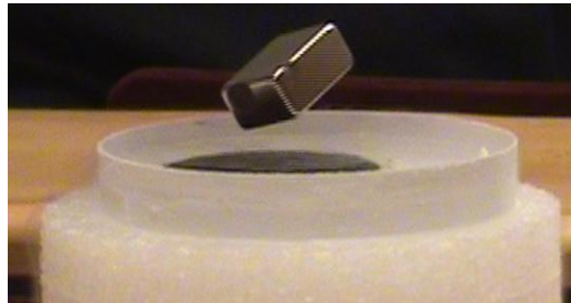
Figure 3 : la lévitation magnétique. La pastille noire posée dans la coupole est un supraconducteur refroidi par de l'azote liquide. Un aimant est approché : il est repoussé par la pastille et flotte à quelques millimètres au-dessus du support.
