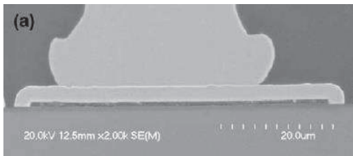
Figure 194: Fil de bonding en cuivre avec finition ENEPIG [128]
