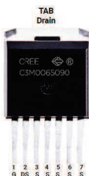
Figure 39: 900V MOSFET SiC en boîtier 7L D2PAK [68]
