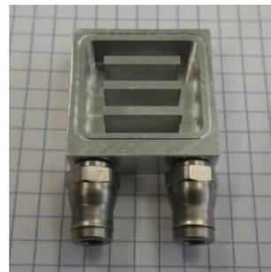
Figure 131: Vue de l'intérieur du bloc à eau
