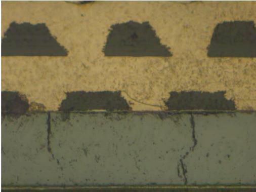
Figure 200: Fissure verticale entre drain et source
