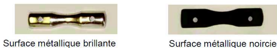
Figure 3.15 Ajustement de l'émissivité avec une surface partiellement noircie
