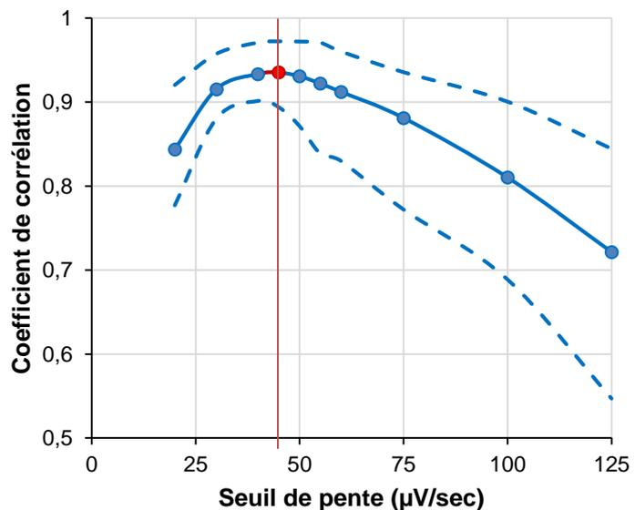
$r = 0,96$ ,  $p < 0,001$  ; *Figure II.14*). Pour détecter les REM, l'application de notre utilitaire avec ce seuil, est donc une méthode fiable, qui donne des résultats très proches de ceux obtenus par analyse manuelle.
