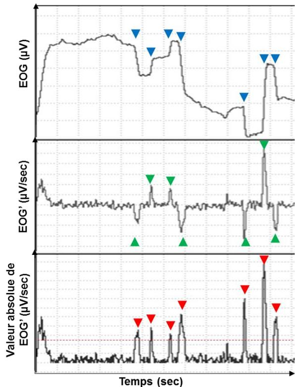
**Figure II.13 : Détection des REM en fonction des variations de pente.**
