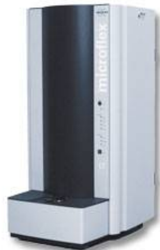
Figure 32 : Maldi Biotyper™ utilisé pour établir une empreinte moléculaire des différentes bactéries cultivées isolées.
