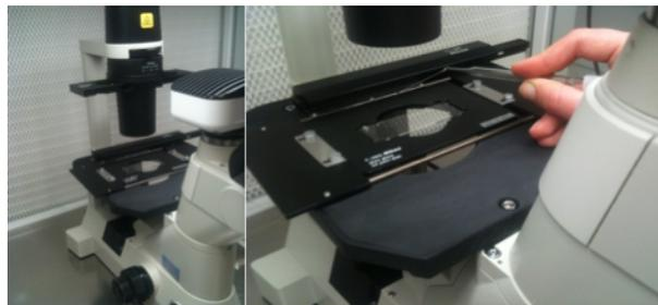
Figure 31 : Isolement de cellules microalgales au microscope inversé par micropipetage à l'aide d'une pipette Pasteur et dans un environnement stérile (hotte à flux laminaire, instruments stérilisés)
