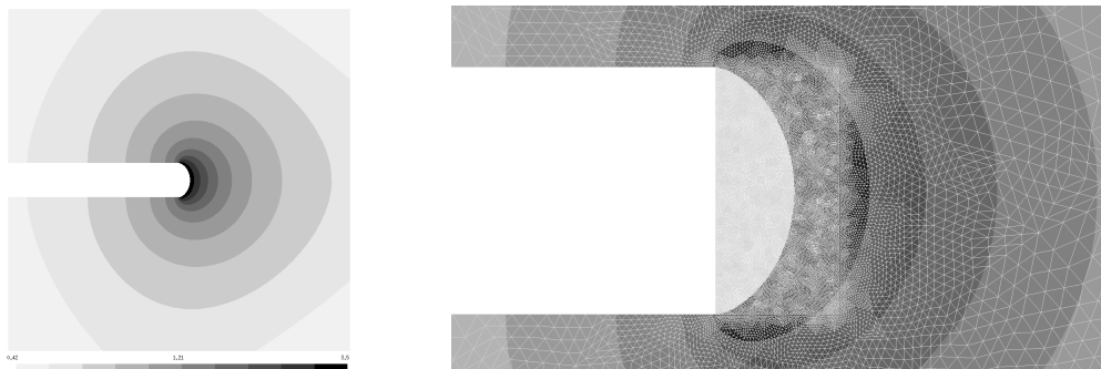
Figure 3.7 – Cisaillement dans le milieu matériel. Le gris clair (respectivement foncé) correspond aux taux de cisaillement faibles (respectivement élevés). À gauche, l'ensemble du domaine. À droite, le détail autour de la zone d'endommagement ou \text{iso-}R_m . Le maillage est visible dans l'image de droite.
