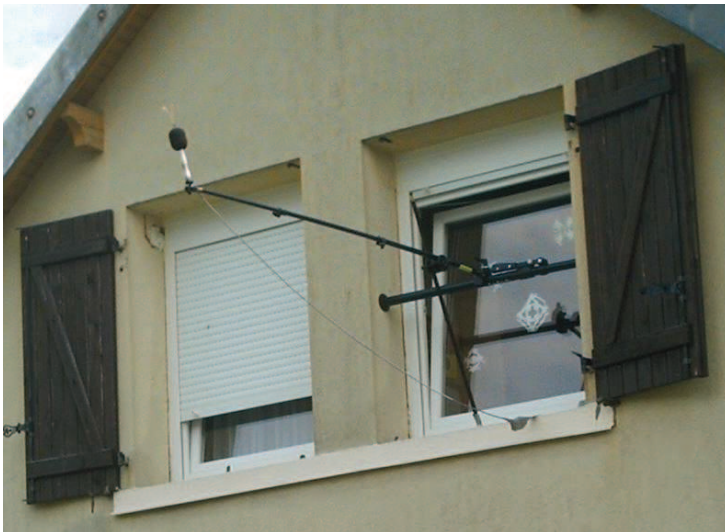
Figure 29 : Perche permettant la fixation du microphone extérieur, à 2m en façade
