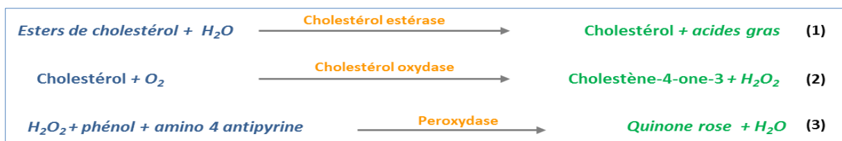
Figure 15 : Principe du dosage du cholestérol
