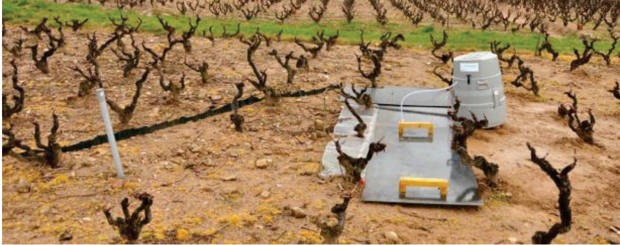
Figure 32 : vue extérieure de la tranchée. Des poignées permettent le déplacement de la tôle pour accéder à l'intérieur de la tranchée. À droite de la tranchée, un préleveur automatique d'échantillons est visible. Sur la gauche, le piézomètre A4, et une bordurette de déviation du ruissellement
