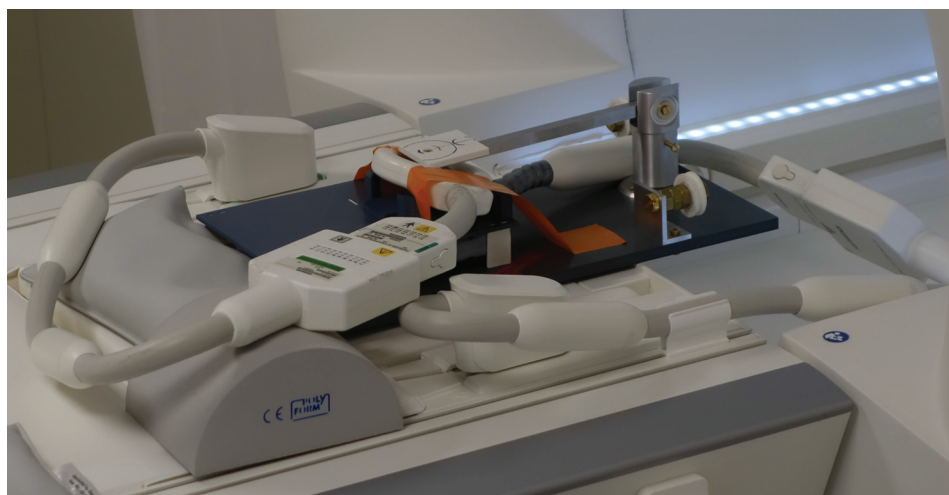
FIGURE E.4 – Dispositif de chargement réalisé en matériaux métalliques amagnétiques, positionné à l'entrée de l'IRM avec deux antennes fixées
