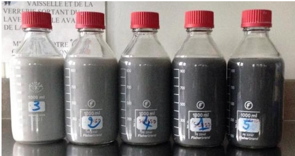
Figure III-8. Photographie des cinq solutions ayant servi à l'étalonnage.
