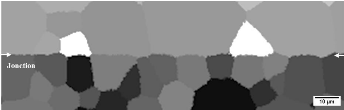
Figure 4.26 : Zoom de la Figure 4.25 (a) au niveau de l'interface ( t=20s soit T=982^{\circ}C ). L'aspect « rugueux » des grains est dû au zoom important de la Figure 4.25 (a).
