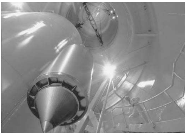
FIGURE 1.8 – A gauche - photo de l’intérieur de la droptower au ZARM Institute à Bremen. La nacelle expérimentale est chargée au sommet de la tour pour une chute libre d’environ 5s [11]. A droite - déroulement d’une parabole à bord de l’A310 AIR ZERO G [12].
