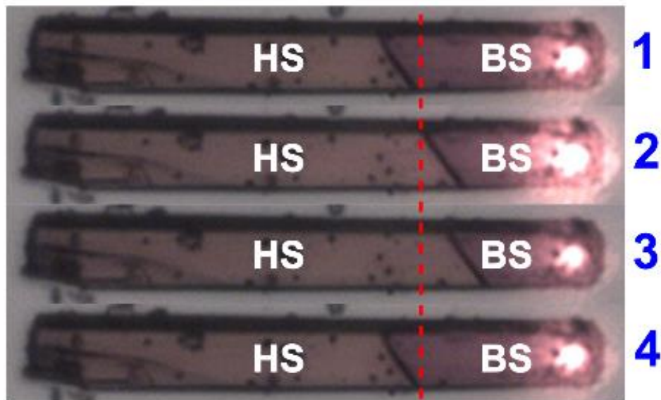
Figure 2-19 : Comportement spatio-temporel de l'interface HS/BS d'un monocristal sous un spot laser modulé à 0.1Hz , avec un bain thermique de 108K. Les images 1 à 4 sont respectivement prises au temps t=9,2s , 10,8s , 12,4s et 18s .
