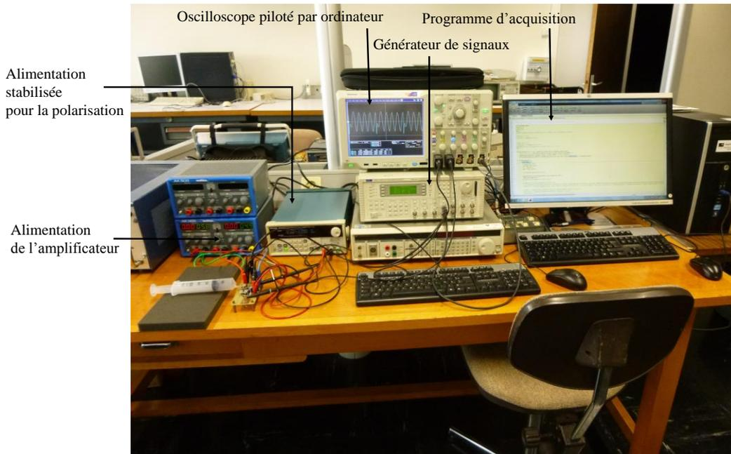
Fig. 14 Photographie du banc de caractérisation automatisé.
