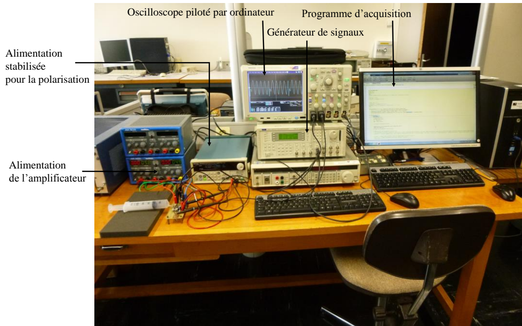
Fig. 14 Photographie du banc de caractérisation automatisé.
