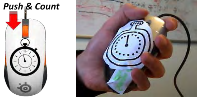
Figure 3-9 : Illustration du prototype "ClicOnMe" pris en main comme un chronomètre ; à gauche, le concept, à droite, le prototype tenu en main. Exemple d'utilisation : « J'appuis sur le bouton de la souris, j'attends. Je perçois un feedback au bout d'une certaine durée, j'estime la valeur transmise».
