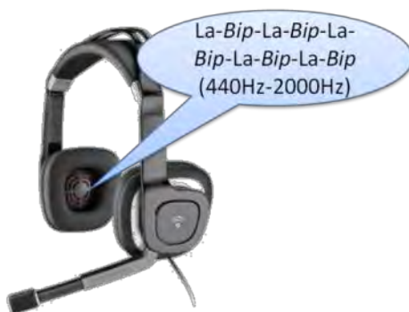
Figure 4-16 : illustration de la technique « BipMultiple ». Exemple d'utilisation : « j'entends un son, dans lequel il y a plusieurs bips, chaque bip marque une vingtaine, j'estime la valeur transmise (dans l'exemple, 100, car 5 bips) ».
