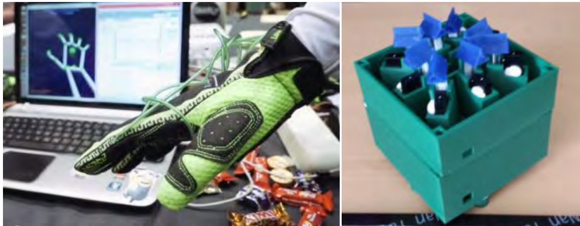
Figure 2-5 : Dispositifs utilisant la modalité haptique de pression. A gauche, illustration d'un « Hands Omni haptic glove », à l'intérieur des coussinets se gonflent afin de reproduire par exemple, la prise en main d'un objet. A droite, illustration d'un HaptiQ, qui transmet une direction à l'aide de picots sous la main.
