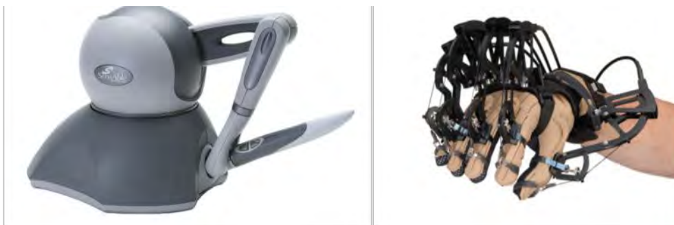
Figure 2-4 : Illustration des dispositifs PHANTOM™ (à gauche) et CyberGrasp™ (à droite).
