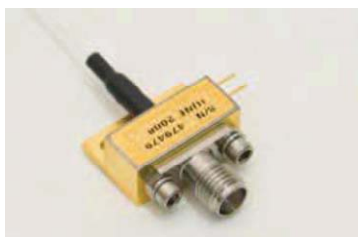
Figure 2.36 : Photographie et schéma du boîtier de la PD
