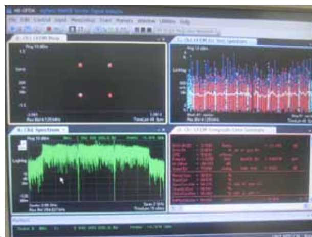
Figure 4.15 : Constellation QPSK avec un EVM de 2.8 % pour un débit de 200 Mb/s
