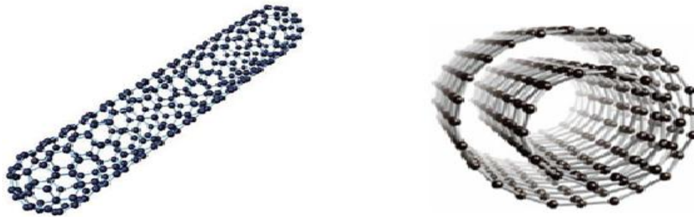
Figure I. 3. Structure géométrique d'un CNT monoparois (gauche) et d'un CNT multiparois (droite).
