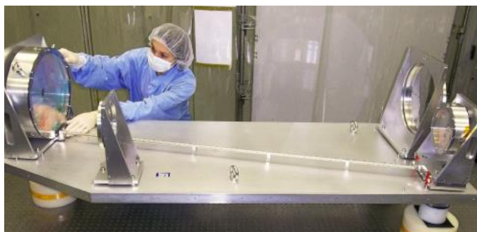
FIGURE 5.9 – Exemple d'un extenseur de faisceau fabriqué par Reosc
