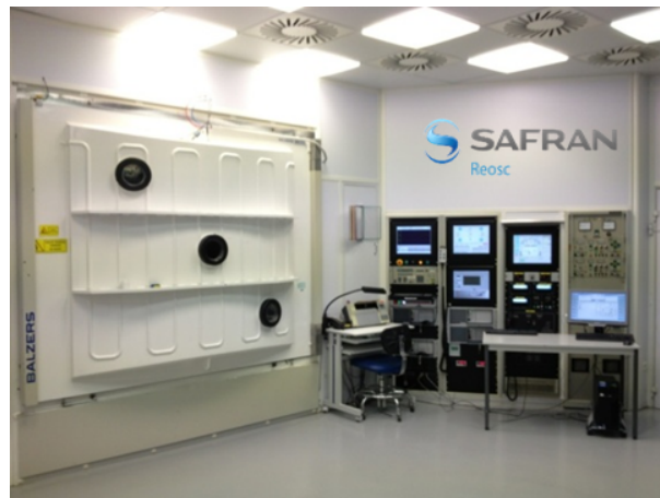
FIGURE 3.11 – Vue, côté salle propre, de la porte de l'évaporateur BAK1730 et de sa baie de commande dans l'atelier couches minces optiques de Reosc
