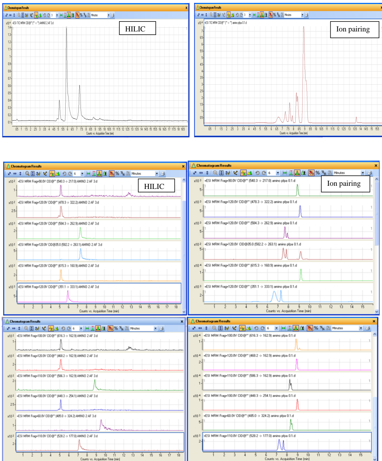
Chromatogramme (TIC et MRM) obtenus lors de la séparation de 12 AGs étudiées avec la colonne ZIC_HILIC et Zorbax Eclipse C18.
