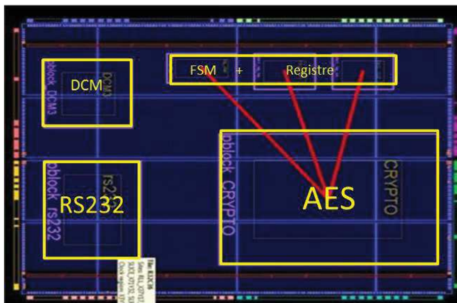
FIGURE 4.8: Placement des différents blocs du circuit de test
