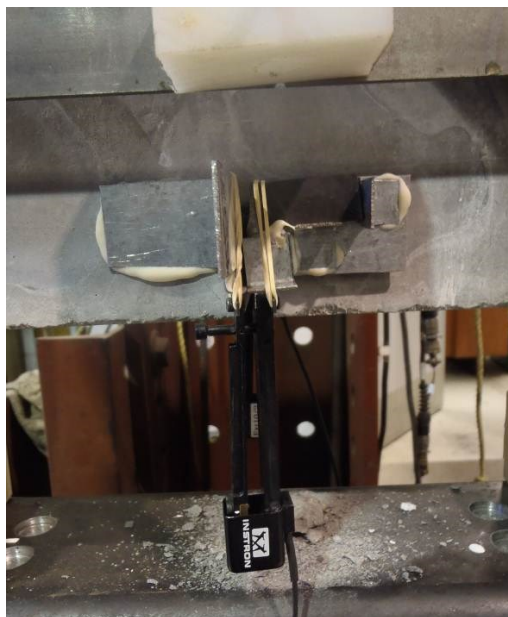
Figure C-13 : Installation d'un extensomètre
