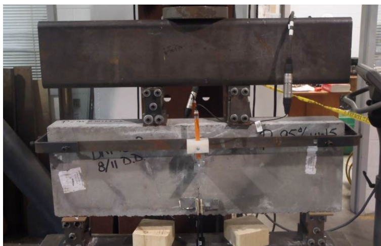
Figure C-10 : Instrumentation des flèches
