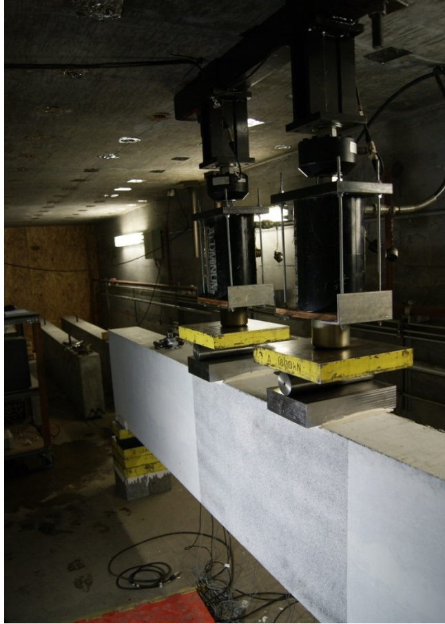
Figure 3.24 : Photo du montage de fluage flexionnel - poutres de 4 mètres
