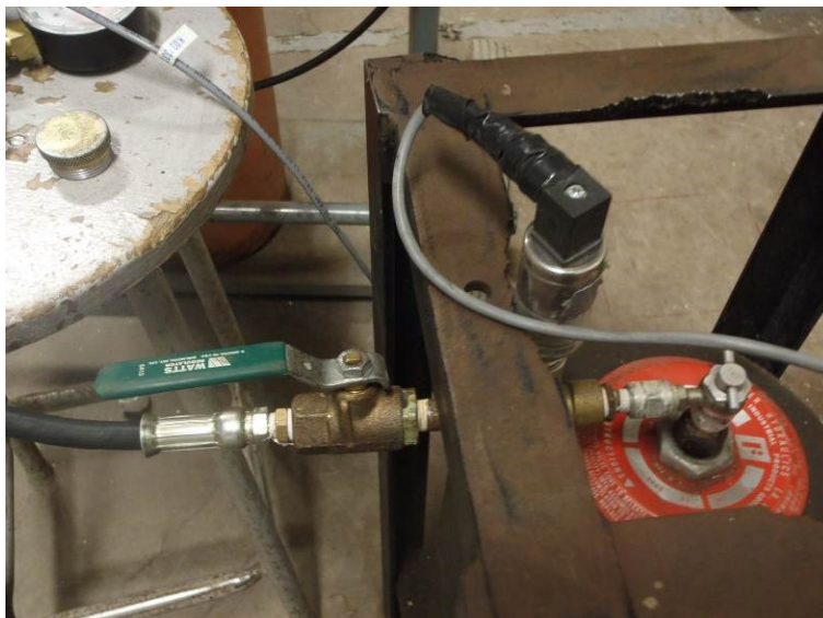
Figure D-16 : Valve VP1 (en vert, position ouverte) et capteur de pression pneumatique
