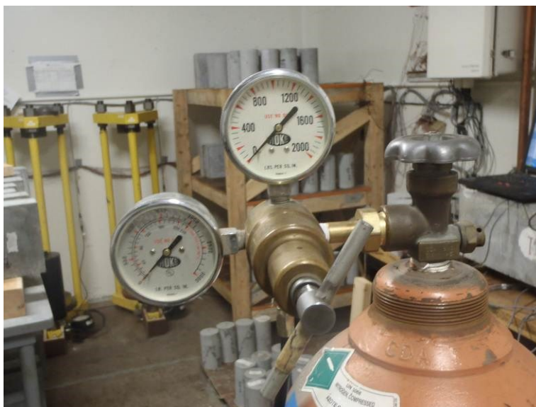
Figure D-15 : Régulateur de pression du cylindre d'azote comprimée
