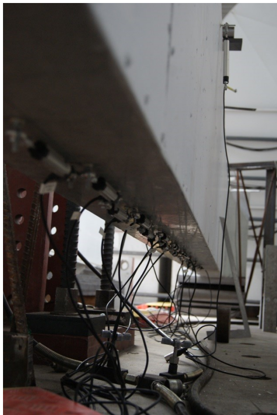
Figure 3.33 : Mesure des ouvertures de fissure – poutre de 8 mètres
