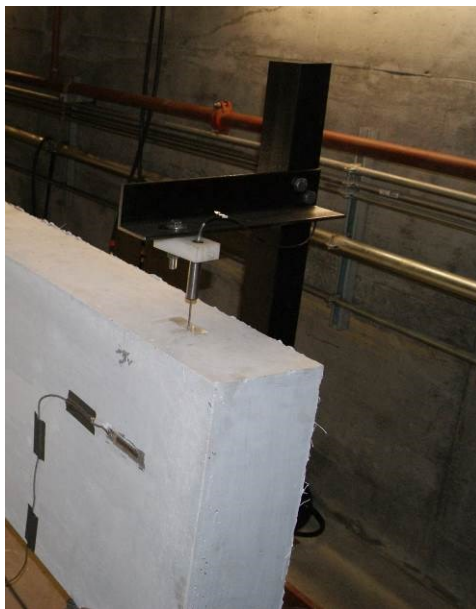
Figure E-9 : Tassement à l'appui
