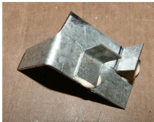
Figure D-6 : Support et LVDT pour la mesure des ouvertures de fissure
