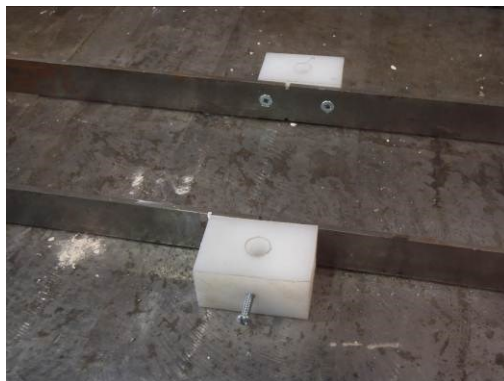
Figure C-9 : Tige d'instrumentation avec supports à LVDTs
