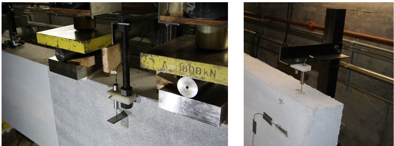
Figure 3.29: Mesure de la flèche – poutre de 4 mètres
