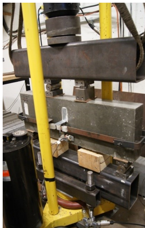
Figure 3.6 : Dispositif de fluage flexionnel
