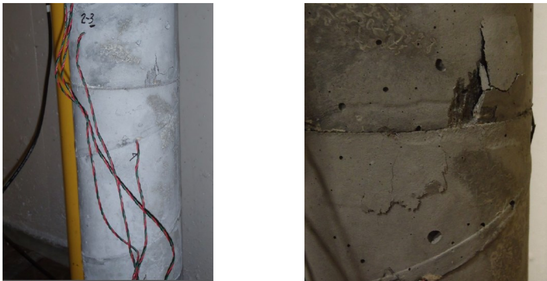
Figure B-2 : Problème de friabilité lors des essais de fluage en compression
