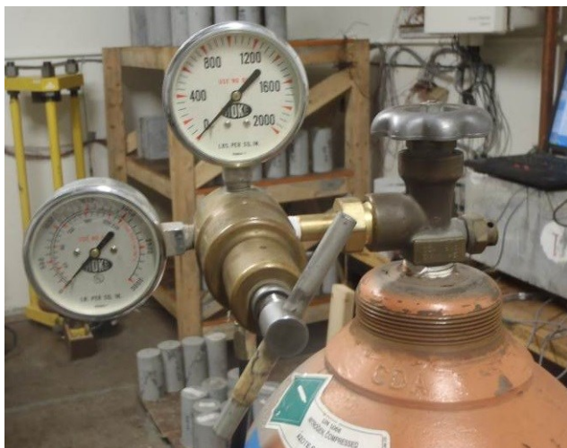
Figure 3.10: Vanne pneumatique du cylindre d'azote (Figure 3.9 - Subdivision 1)
