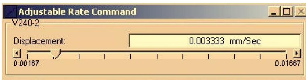
Figure C-20 : Fenêtre pour ajustement du taux de chargement
