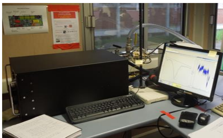
Figure 2.18 : Analyseur COS/CO 2 /H 2 O de marque Aerodyne Research installé pendant 9 mois dans nos locaux de Gif-sur-Yvette.
