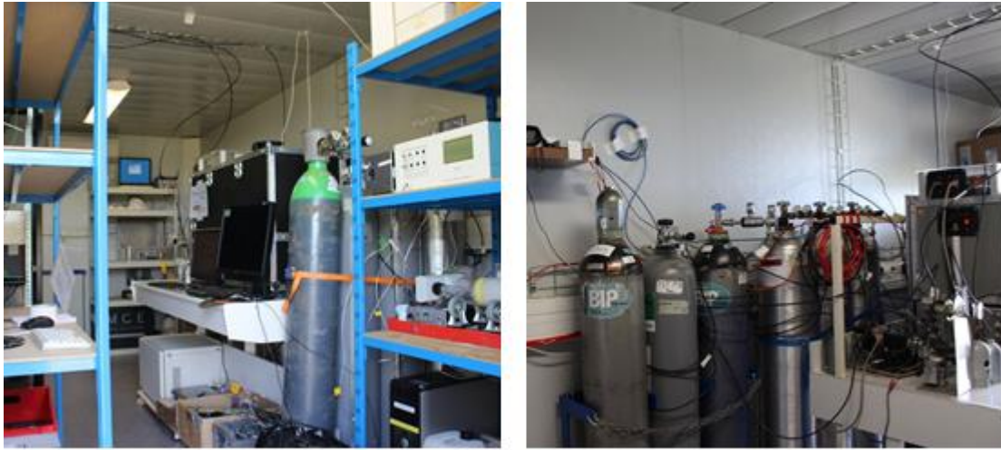
Figure 3.6 : Photos de l'installation FTIR à Trainou. A gauche le FTIR correspond au caisson noir posé sur la table au centre de la salle. A droite, on peut voir les bouteilles (N 2 , gaz cible et gaz étalons) alignées à l'arrière du FTIR (ce dernier étant sur la droite de la photo).
