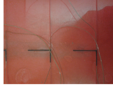
FIGURE 2.15 – Fixation des thermocouples dans la paroi en polycarbonate. (a) Schéma en coupe ; (b) rendu final.
