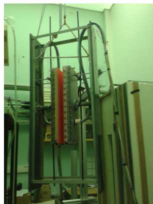
FIGURE 2.3 – La rigidification de la structure (à gauche) permet d'effectuer les réglages avant de plonger l'ensemble dans la cellule (à droite). Photo de la manutention de la structure avant d'être plongée dans la cellule d'eau (au centre).
