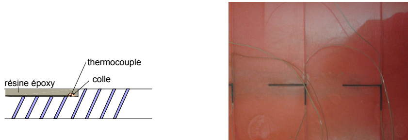
FIGURE 2.15 – Fixation des thermocouples dans la paroi en polycarbonate. (a) Schéma en coupe ; (b) rendu final.
