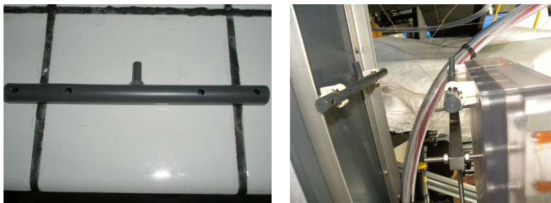
FIGURE 2.12 – À gauche, photo d'un diffuseur avant montage ; à droite, photo d'un diffuseur d'aspiration monté sur la plaque support et d'un diffuseur de refoulement monté sur le bloc paroi.
