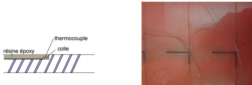
FIGURE 2.15 – Fixation des thermocouples dans la paroi en polycarbonate. (a) Schéma en coupe ; (b) rendu final.
