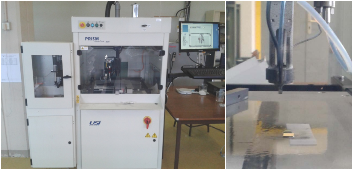
Figure 127: Appareil de spray industriel: à gauche spray USI et à droite la tête de spray.
