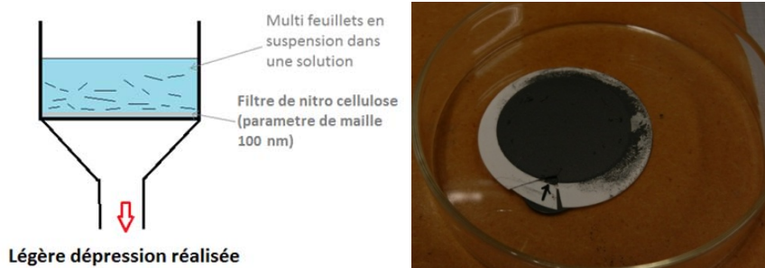
Figure 38: A gauche schéma d'un Buchner servant à filtrer une suspension de graphène, à droite photo d'un film.
