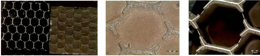
Figure 88. Faciès de rupture d'une éprouvette TP type B (rupture cohésive dans la colle)
