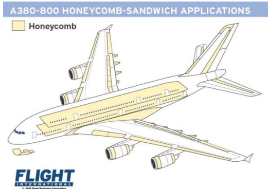
Figure 2. Exemple d'applications des structures sandwichs
