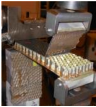
Rupture de la peau en flexion (DCB)
