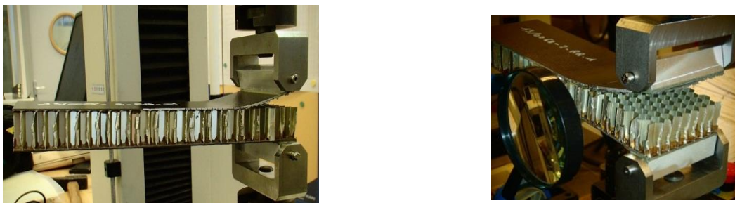
Figure 92. Montage d'un essai DCB sandwich (réalisé au laboratoire d'Aircelle)
