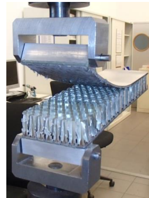
Figure 121. Courbes de propagation REF-1-A-04 à 06 et photo du montage DCB sandwich
