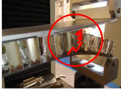
Figure 123. Epreuve REF-I-C-04 à 06 : rupture du Nida et propagation à l'interface peau cocuite / Nida
