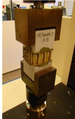
Figure 81. Montage d'un essai de traction perpendiculaire
