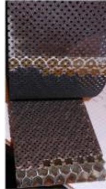
Délaminage de la peau précurée acoustique
