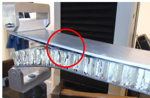
Figure 119. Décollement de la contre-plaque au cours de l'essai (REF-1-B-03)
