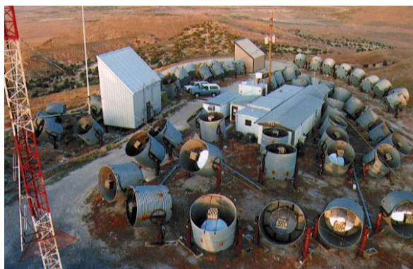
FIGURE 1.3 – Gauche : détecteur de rayons cosmiques Fly's Eye dans l'Utah. Chaque module est constitué d'un miroir réfléchissant la lumière UV sur des photomultiplicateurs. Droite : HiRes II, Utah.
