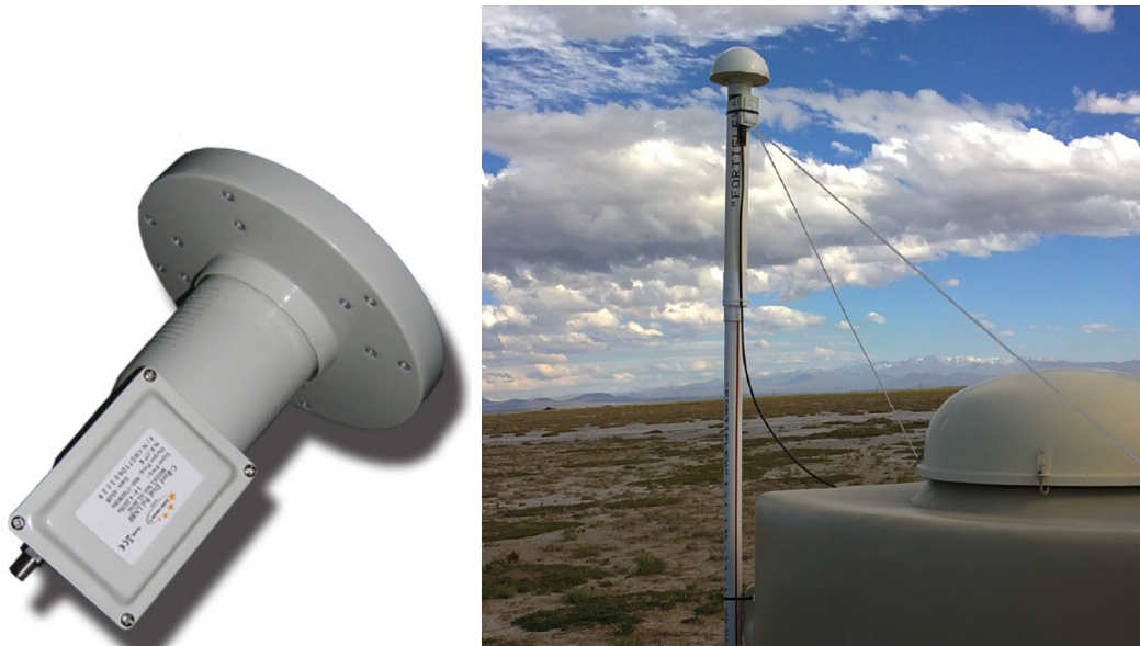
FIGURE 4.10 – Gauche : antenne Golden Interstar GI-301SC Single C-band LNBf avec collerette. Droite : Golden Interstar installée sur le côté d’une cuve du réseau SD et surmontée d’un radôme. Un mat supporte l’antenne et est attaché à la cuve. Entre le mât et la cuve sont tendues des cordes en nylon. Un câble relie le LNB à l’électronique. Un radôme en fibre de verre recouvre l’antenne afin de la protéger de la pluie.
