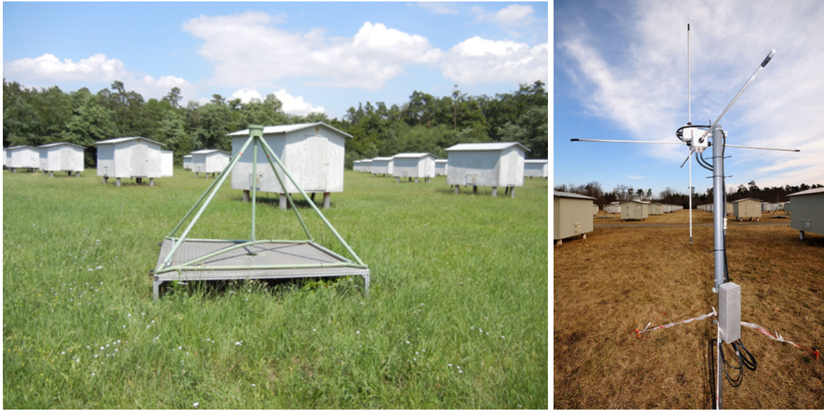
FIGURE 3.6 – Antennes LOPES situées à l’intérieur du réseau de détecteurs de particules KASCADE. Gauche : antenne en V inversé. Droite : antenne LOPES-3D constituée de 3 dipôles croisés [113].
