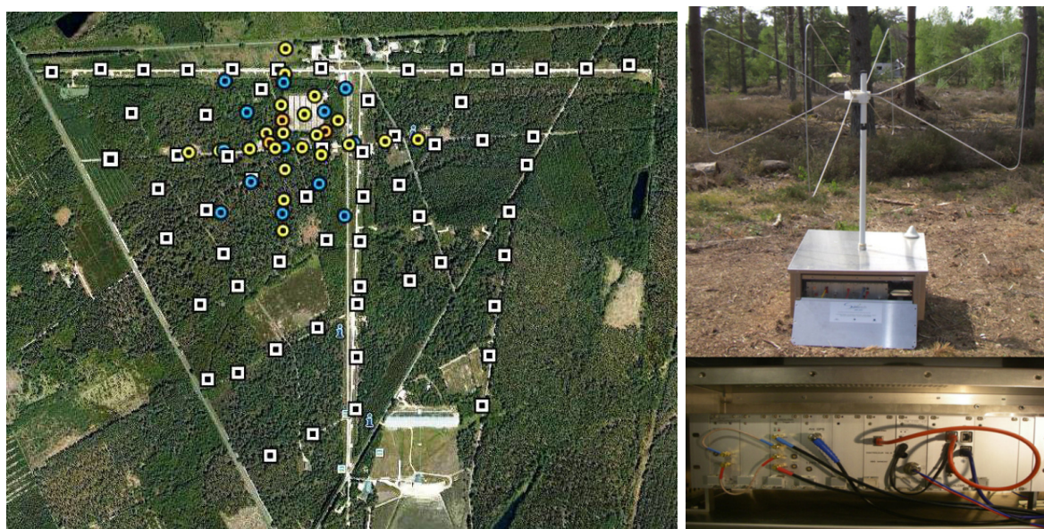
FIGURE 3.12 – CODALEMA III [120]. Gauche : vue aérienne du site. Les carrés blancs représentent les antennes butterfly , les ronds jaunes les antennes dipolaires orientées E-W, les ronds orange les antennes dipolaires orientées N-S, et les ronds bleus les détecteurs de particules. Droite : double antenne butterfly et son électronique.
