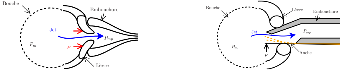
FIGURE 2.16 – (Gauche) Schéma d'une embouchure de trompette. (Droite) Schéma d'une embouchure de clarinette.
