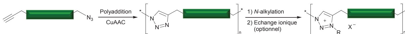
Schéma II.16: Stratégie générale pour la préparation des TPILs via une stratégie de polyaddition AB+AB par CuAAC.
