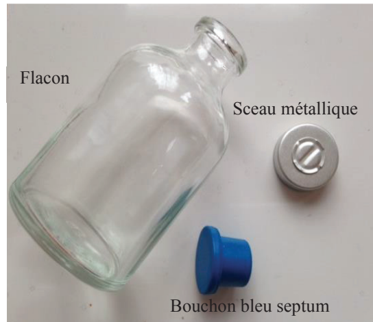
Figure 2.8: Flacon utilisé dans cette étude pour effectuer la réaction de serpentinisation à 80 °C et pression ambiante.
