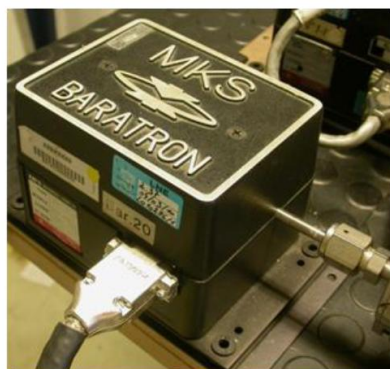
FIGURE 4.5 – Jauge de Baratron et son principe de fonctionnement
