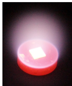
FIGURE I.15 – Synthèse MPECVD homoépitaxique d'un diamant monocristallin sur substrat HPHT commercial de 4 \times 4 \text{ mm}^2 .
