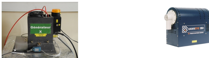
FIGURE IV.11 – Photo des deux tubes à rayons X utilisés pour caractériser les smart-windows.
