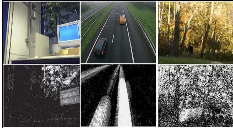
Figure 12. Exemples de modélisation de fond dans différentes scènes avec la version améliorée de GMM [Zivkovic 2004]. Le modèle de mélange comporte un nombre variable de composantes gaussiennes en fonction de la dynamique de la scène
