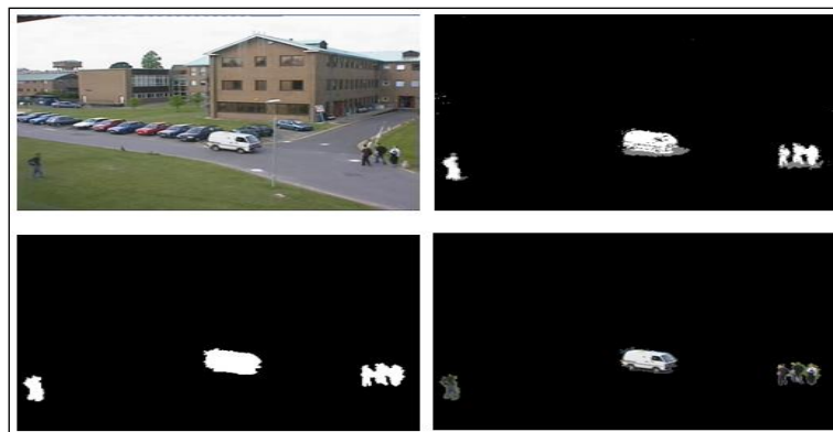
Figure 15. (Haut Gauche) Image originale. (Haut Droite) Image avant-plan : Objets en mouvement en blanc; ombres portées en gris. (Bas Gauche) Masque des blobs extraits. (Bas Droite) Régions d'intérêt extraites
