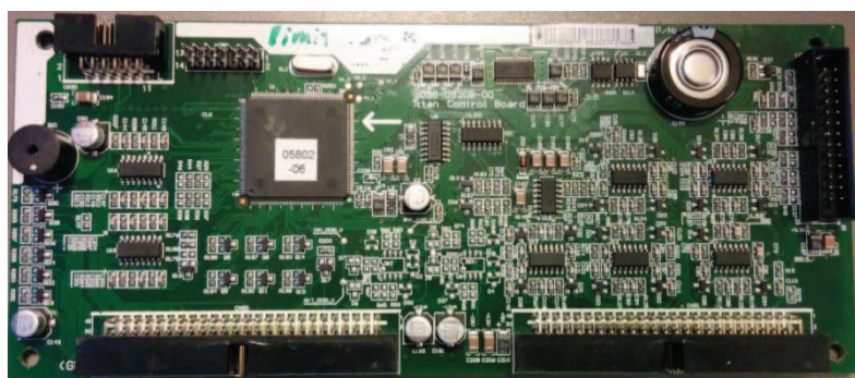
Figure IV-5 : La carte de contrôle utilisée pour l'acquisition des mesures et la commande de la maquette
