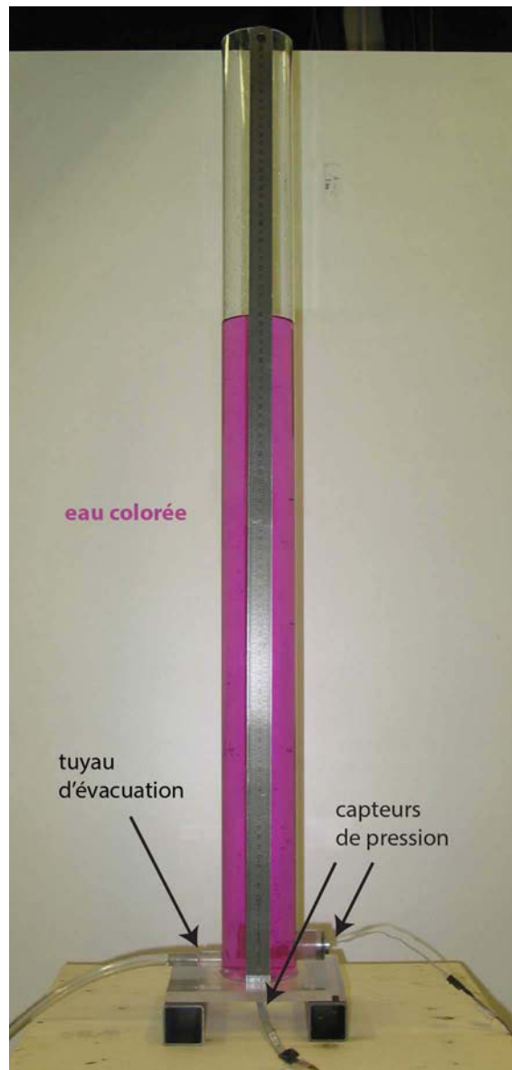
Figure 3.10 : dispositif de calibration des capteurs de pression par variation de hauteur d'une colonne d'eau.
