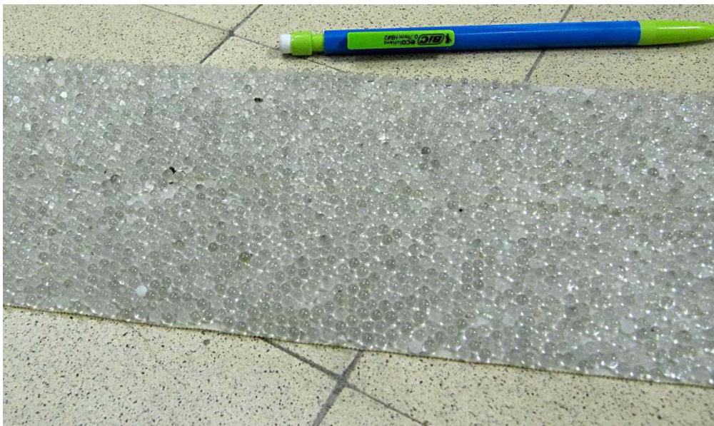
Figure 3.4 : portion de bande plastique sur laquelle ont été collées des billes de verre de 3 mm et qui est ensuite placée à la base du chenal pour servir de substrat rugueux.
